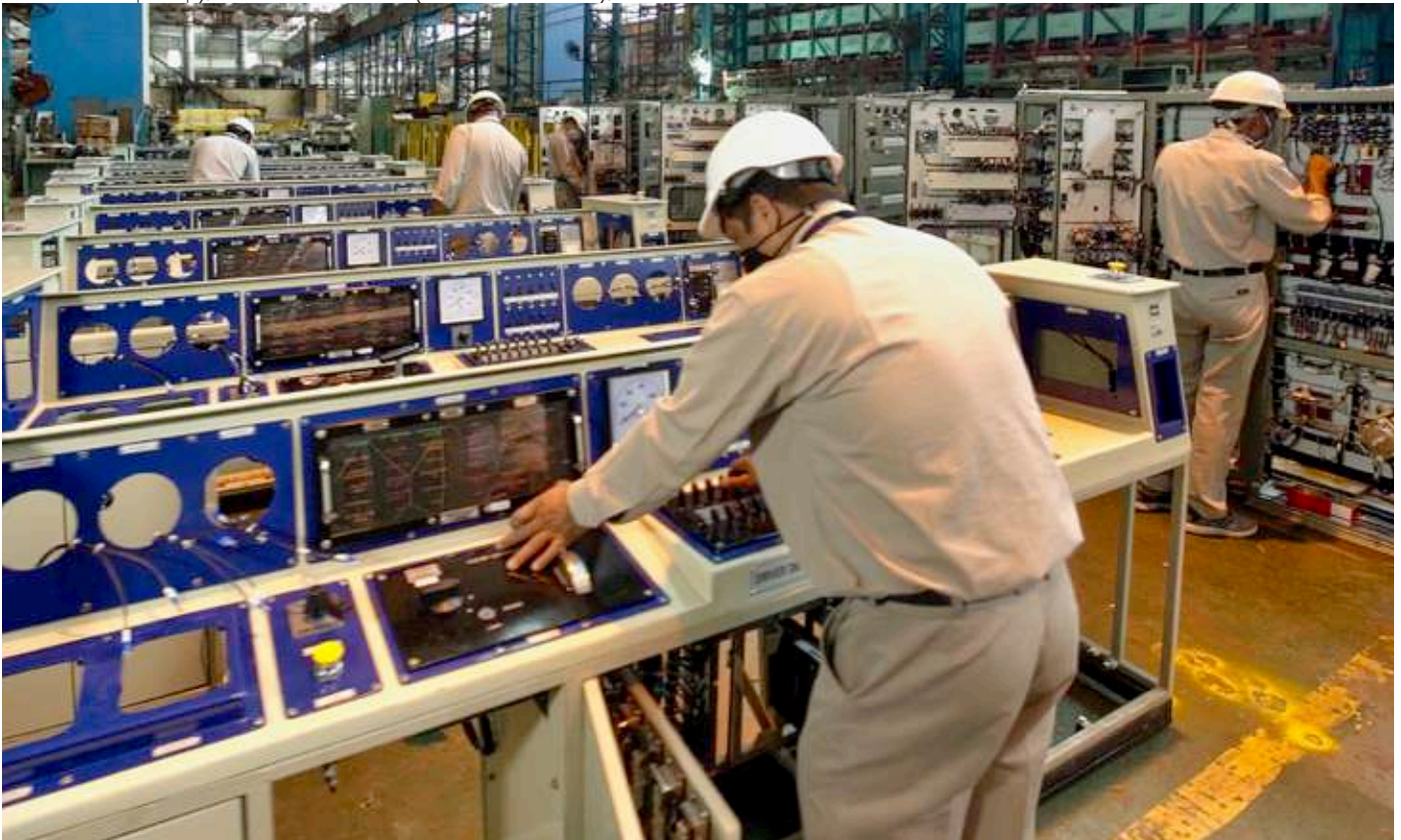
बीएचईएल भोपाल के स्विचगियर डिविजन (एससीआर) में डीईटीसी (डीजल इलेक्ट्रिक टावर कार) के लिए नियंत्रण प्रणाली विनिर्माण केंद्र
