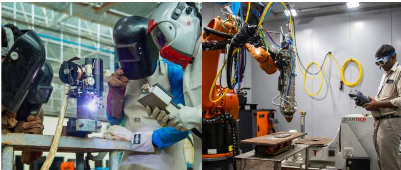
वेल्डिंग रिसर्च इंस्टीट्यूट, बीएचईएल तिरुचिरापल्ली में परिक्रमिय परीक्षण मशीन परीक्षण सेटअप (बाएं) और रोबोटिक आर्म लेजर वेल्डिंग सेटअप (दाएं)
