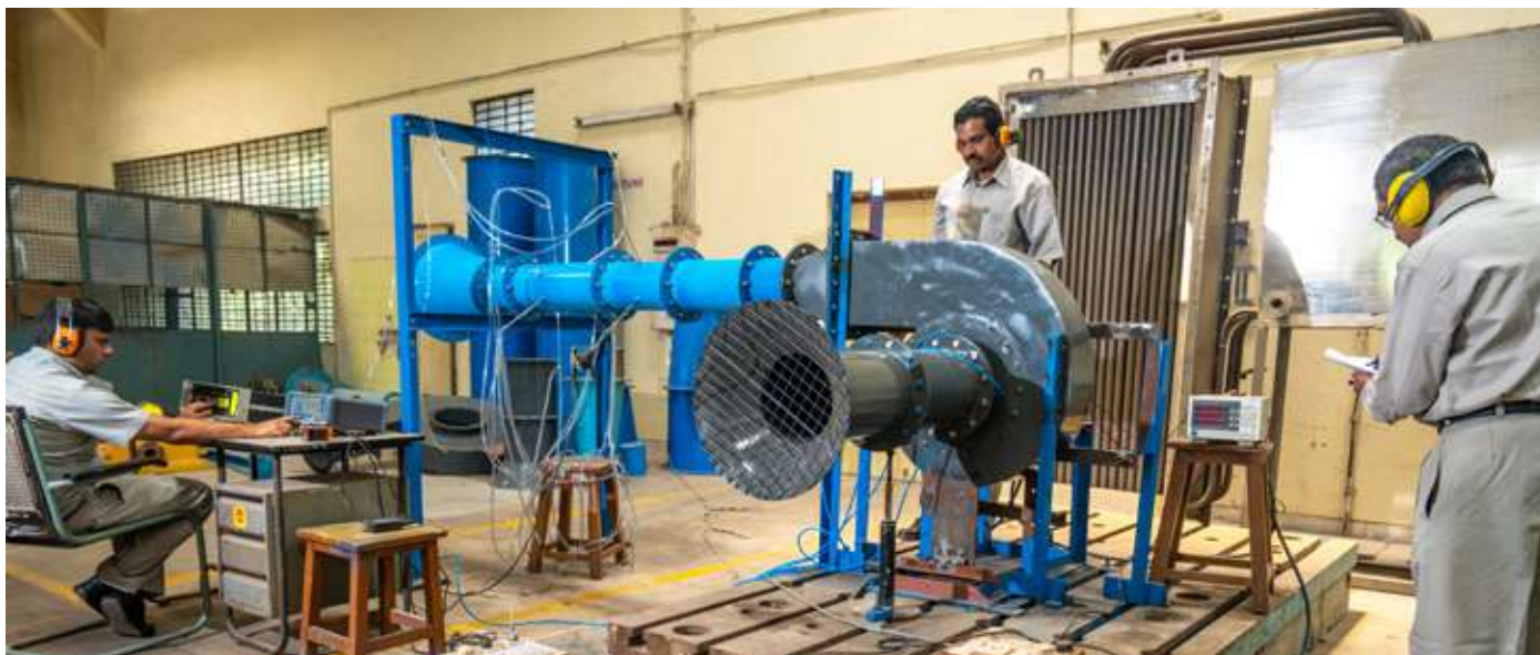
कॉर्पोरेट आरएंडडी, बीएचईएल हैदराबाद में हीट ट्रांसफर तथा फ्लूइड फ्लो के लिए सेंटर ऑफ एक्सिलेंस में रेडियल फैन टेस्ट
