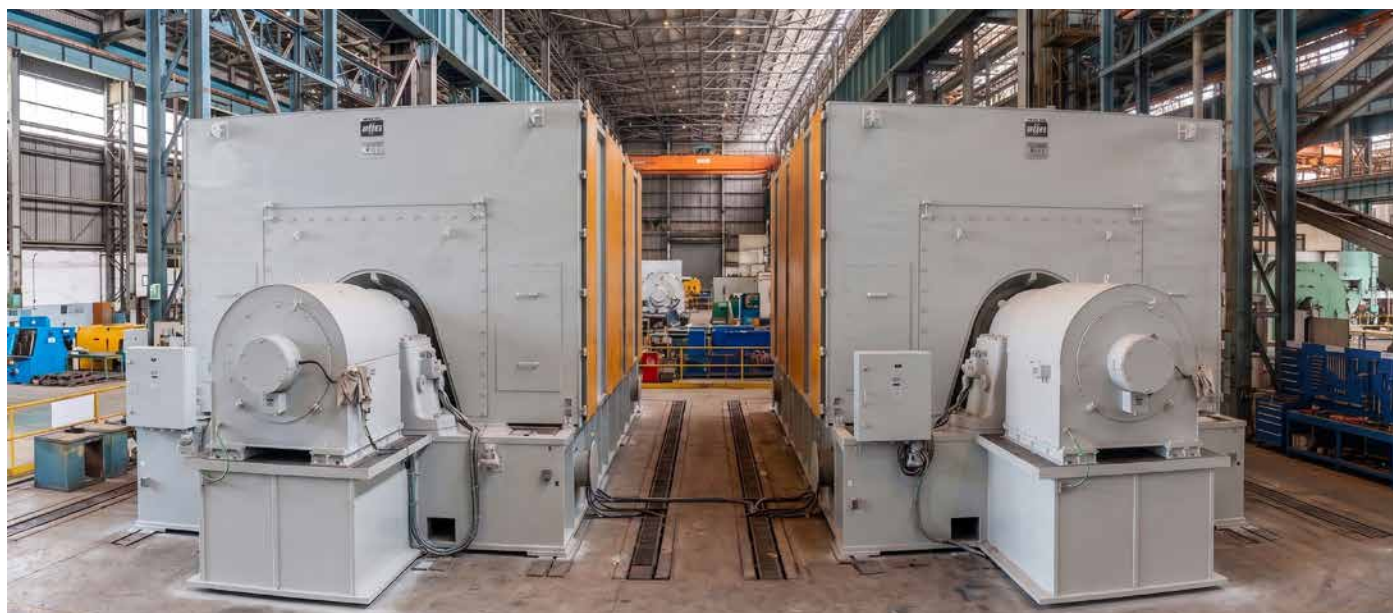
बीएचईएल के उच्चतम क्षमता-रेटिंग वाले वायु-शीतित (एयर-कूल्ड) समकालिक जनरेटर - बोत्सवाना के जिंदल ममाबुला ऊर्जा परियोजना के लिए निर्मित 175 मेगावाट क्षमता के 4 जनरेटर
