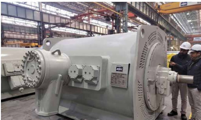
बीएचईएल भोपाल के शॉप फ्लोर में फ्लेमप्रूफ मोटर
