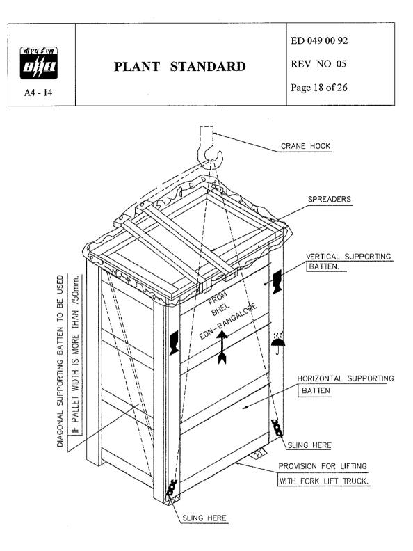
FIG-6 : LIFTING OF PACKED CASE
